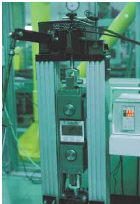
Foto 1.13: Banco prova per carichi fino a 150 MPa e temperature fino a 250°C
