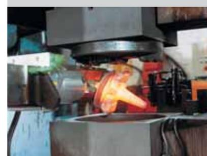
Foto: 1.9: Cuscinetto iglidur® X in uso ad alte temperature, dovute all'ambiente di fonderia
