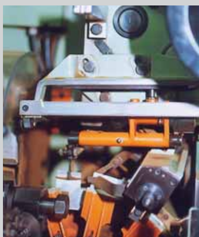
Foto 5.1: Grazie all'impiego di iglidur® W300, la durata del cuscinetto su questa etichettatrice per bustine di tè è quintuplicata
