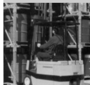
Foto 2.2: test con carico operativo di 18.000 N; dopo 10.000 manovre non si è riscontrata usura significativa dei cuscinetti
