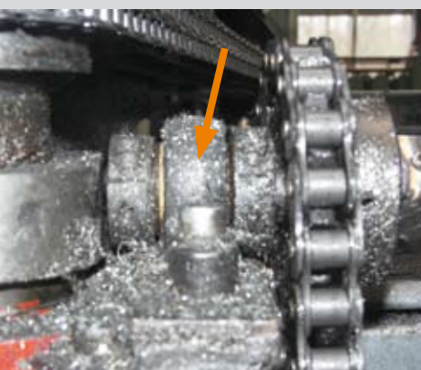
Supporto igubal® esente da ma- nutenzione, nessun problema con trucioli, olio e sporcizia Swarfs, oil and dust: Maintenance-free igubal® pillow block bearing in a interlacing machine
