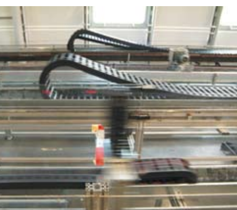
Prove di tenuta con velocità 10 m/s e accelerazione di 200 m/s² Push Pull forces speed up to 10 m/s, acceleration up to 200 m/s² are tested
