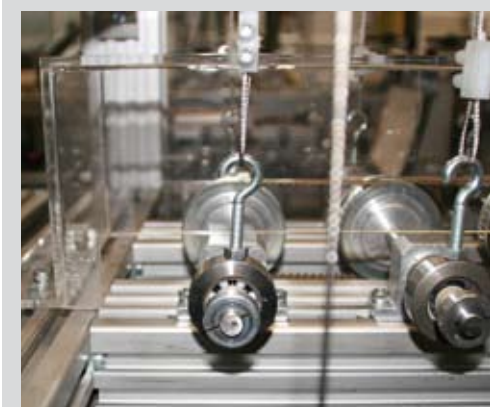
Test nel laboratorio igus® sui cusci- netti a sfere Tests of ball bearings in igus® lab
