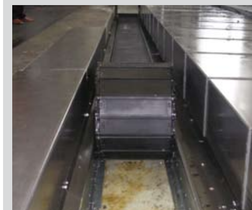
Catena chiusa con corsa di oltre 20 m in una macchina utensile E-Tube with more than 20 m travel on a machine tool
