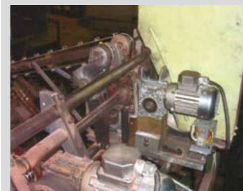
Oltre 170.000 euro di risparmio grazie all'impiego dei sistemi di scorrimento lineari DryLin® R More than 170,000 euro benefits thanks to the use of DryLin® R linear guiding in a radiator pipe band grinder
