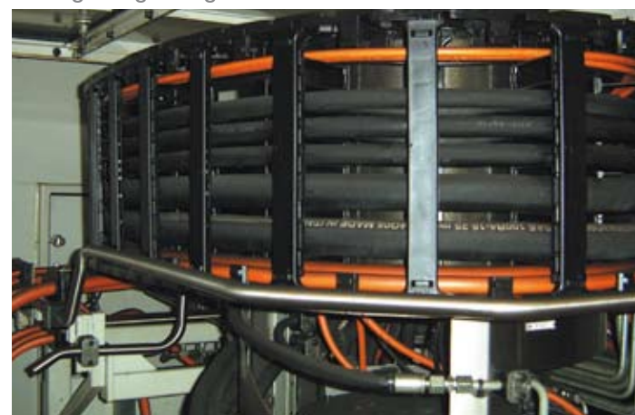
Catena serie E6 in un centro di lavoro: Lo speciale design in 6 pezzi e il basso peso garantiscono un funzionamento senza problemi E-Chain® E6 in a CNC grinding machine: It six-piece design and minimum weight permit extremely smooth movements
