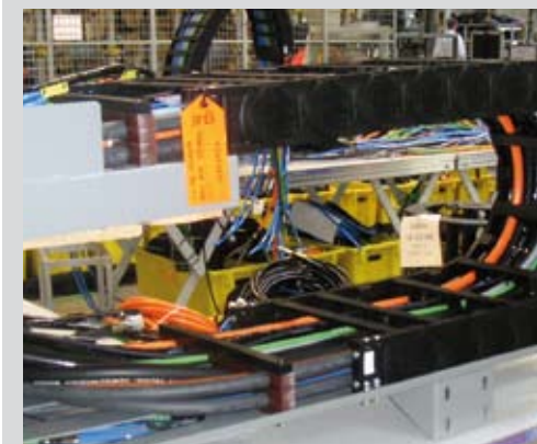
Sistema per catene portacavi pre-assemblato, fornito pronto per l'installazione Complete harnessd E-ChainSystem® – delivered pre-finished
