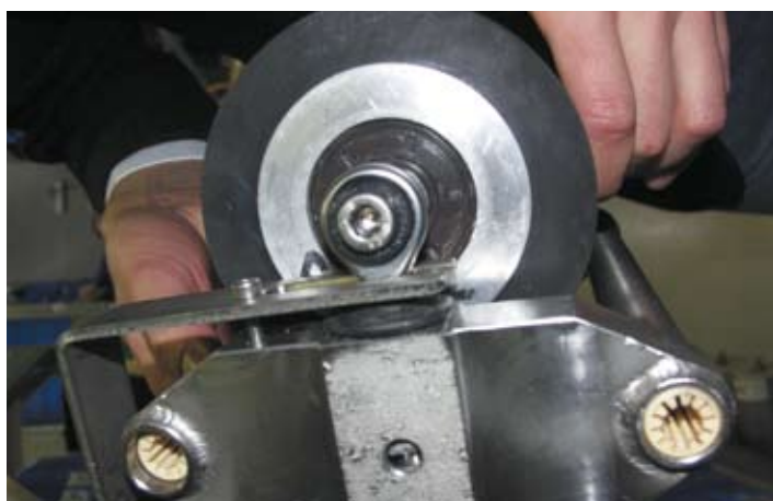
Cuscinetti in tecnopolimero in una macchina per la tornitura e la rettifica per l'industria della stampa Polymer bearings in turning and grinding machines for printing industry
