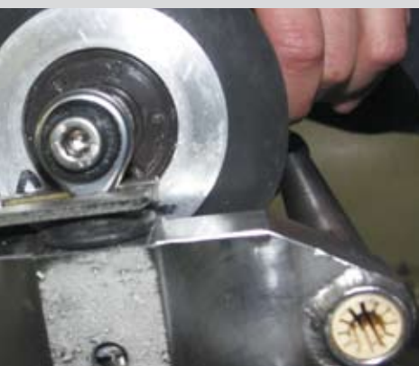
iglidur® J inella testa per la pulizia della carta iglidur® J in paper poli- shing header
