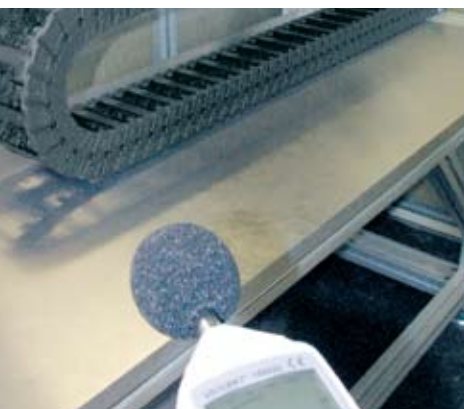
Prova di rumorosità all'interno del laboratorio acustico igus® Noise level test insid an igus® acoustic cell
