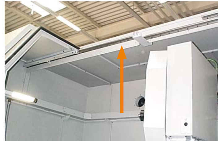
Funzionamento silenzioso grazie alle guide DryLin® nelle porte delle macchine utensili Smooth and silent operation due to Dry-Lin® in the doors of machine tool
