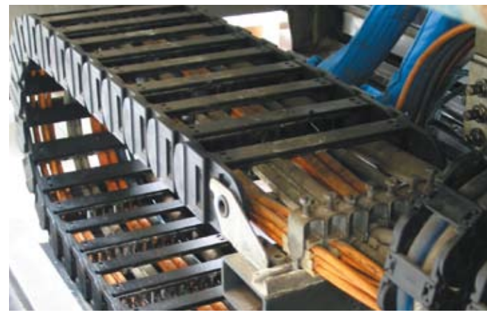
Al top anche dopo nove anni di funzionamento: catena portacavi in una macchina di tornitura e rettifica ad alta precisione Top condition even after nine years: E-Chain® in a high precision turning and grinding machine
