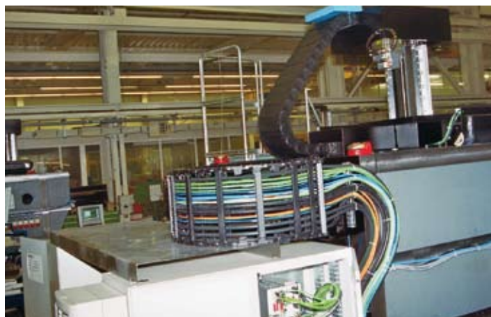
Risparmio di spazio: Catena per l'asse x sopra la copertura superiore della macchina Save space: Horizontal x-axis of E-Chain® on top of machine cover
