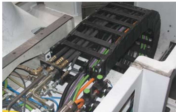
Catene portacavi preassemblate con fissacavi integrati in un centro di lavoro Pre-harnessed energy chain with integrated strain relief in machine centre
