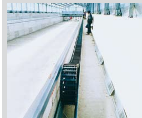
Corsa lunga - Sistema E4, corse fino a 500 m Long travel - System E4 up to 500 m
