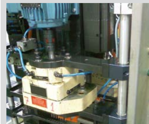
DryLin® R per il movimento verticale e DryLin® W per quello orizzontale in presenza di emulsione da fresatura Machining with DryLin® R linear bearings vertical and DryLin® W guides horizontal in drilling emulsions
