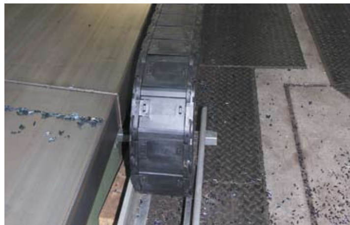
Catena chiusa HT: Nessun problema con trucioli anche alle alte temperature HT E-Tube: No problems with chips and high temperatures
